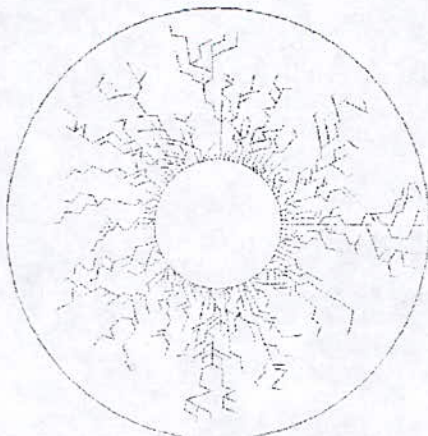
Fig. 11 : Décharge pour R1=3\text{cm} , D=7\text{cm} Tension appliquée 28 kV Tension expérimentale= 36 kV
