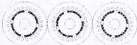
Fig.1. Principe de segmentation des aimants en plusieurs sous-aimants de même polarité
