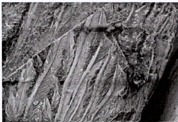
Fig. 11. Matériau A. Micrographie MEB après 16 heures d'immersion au potentiel de corrosion. (G. 500)
