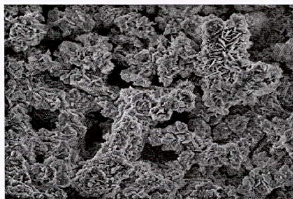
Fig. 12. Matériau B. , Micrographie MEB après 16 heures d'immersion au potentiel de corrosion. , (G. 500)
