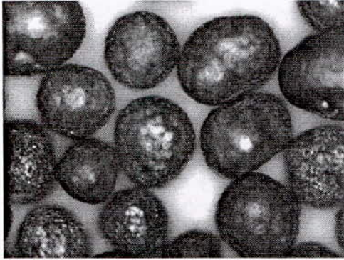
Fig. 8 Forme des particules de poudres retenues dans les tamis 150 et 160 \mu\text{m} ( G = 100 \text{ X} ).
