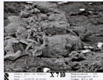
Fig. 23. Faciès de rupture du multimatériau AU4G/10E/15E pour une fissure transversale.
