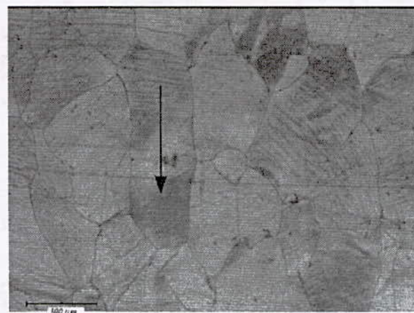
Fig. 3. Micrographies prises sur le plan de laminage des échantillons homogénéisés à 540°C et laminés pour des taux de laminage ; (a) 10%, (b) 20%, (la flèche indique la direction du laminage)
