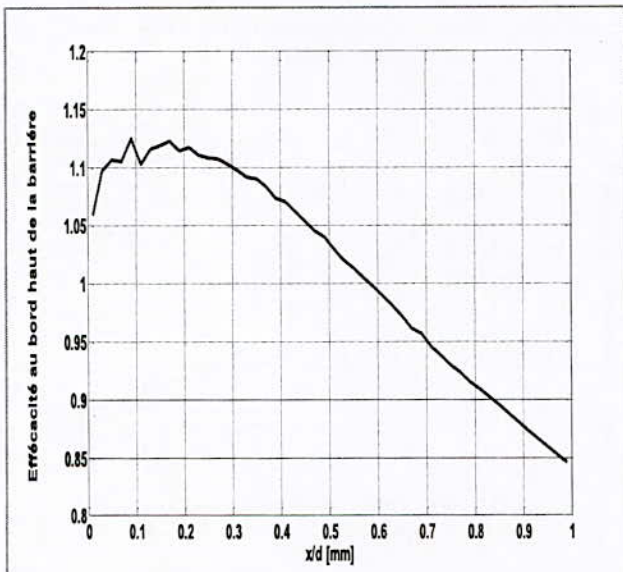
Fig.14 : Variation de l'Effacité 2 en fonction de la position de la barrière en présence de décharge.
