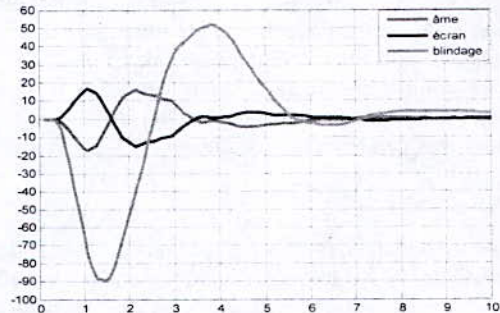
Figure 14: Courant induit à la deuxième extrémité du câble pour les trois couches.
