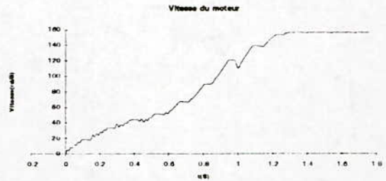
Fig5- Caractéristiques de la machine triphasée avec la commande par train d'onde (7:5)
