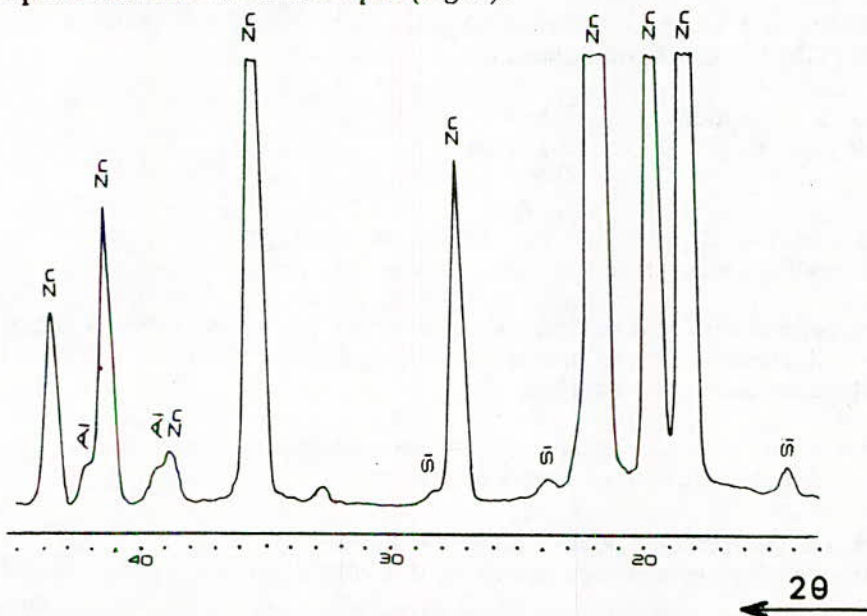
Fig.4: Spectre de diffraction X rasants de l'Alpax décapé.
