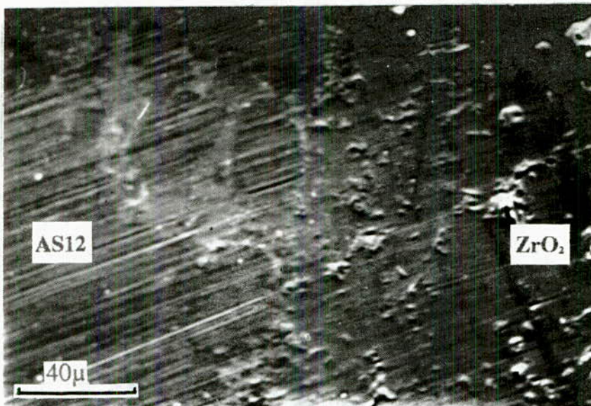
Fig.10: Micrographie (M.E.B) de l'assemblage AS12/ZrO 2 . "Slurry-coating Sn-Cu" + post-traitement de 3 j à 300 °C.
